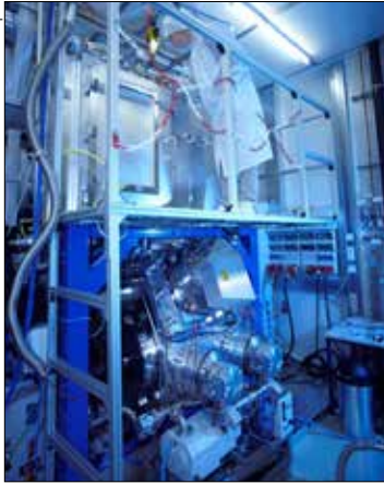
Ansicht der Ionenstrahl-Zerstäubungsanlage für Grundlagenuntersuchungen zu Beschichtungsvorgängen im Rahmen des Exzellenzclusters QUEST
