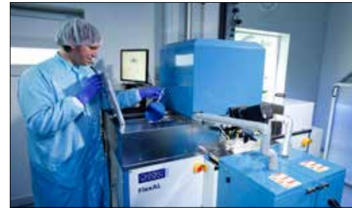
Beschichtung eines Silizium-Wafers mittels Atomic Layer Deposition (ALD)
