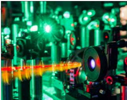
Zwei-Farben-gepumpter optisch parametrischer Verstärker zur Erzeugung von Einzyklen-Laserpulsen
