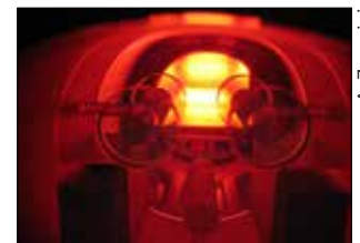
Hochfinesse Resonator im Vakuum
