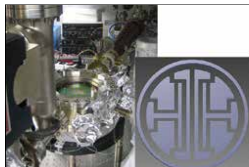
Links: UHV-Vakuumanlage zur Erzeugung ultrakalter NaK-Moleküle. Rechts: Elektrodenstruktur der Hauptkammer zur Kontrolle der molekularen Wechselwirkung durch E-Felder.
