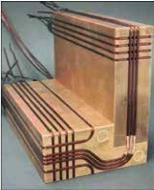
Mesoskopischer Atomchip zur schnellen Erzeugung ultra-kalter Ensemble
