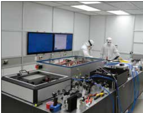
Installation des stabilisierten 200W Lasersystems am Advanced LIGO Gravitationswellendetektor in Hanford (USA)
